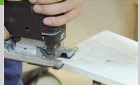
am Turm. Im Trog wird mit einem Forstnerbohrer (D = 35 mm) eine 5 mm Vertiefung gebohrt. Ein Brett mit einem 35 mm Loch dient dabei als Bohrerführung. Zeichnen Sie jetzt die Konturen der beiden Teile auf und schneiden Sie sie mit einer Stichsäge aus. Beide Teile werden von innen mit dem Turm verschraubt.
