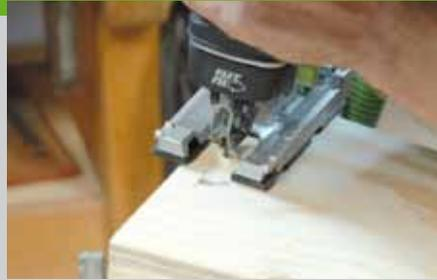
einer Feile. Zeichnen Sie die Position des Futterloches auf dem Turm an. Bohren Sie in den unteren Ecken jeweils ein 8 mm großes Loch und sägen Sie den Bogen mit einer Stichsäge mit Kurvensägeblatt aus. Verschrauben Sie die Einzelteile der Halterung für das Rohr miteinander.
