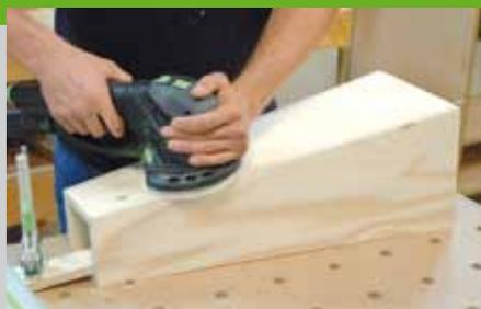
Art miteinander verklebt. Nachdem der Kleber trocken ist, werden die Seiten des Turmes mit grobem Schleifpapier (Körnung P 80) bündig geschliffen. Schneiden Sie die Bodenplatten (Pos. 3 + 4) des Turmes zu. Die kleinere Bodenplatte wird so geschnitten, dass sie genau zwischen die Wände passt.
