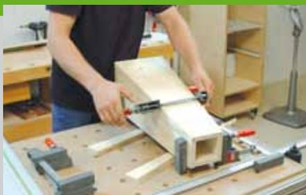
2. Verkleben Sie die vier Wände miteinander. Für die Verklebung wird entweder ein wasserfester Holzleim oder ein Polyurethan-Kleber verwendet. Zusätzlich können Sie die Klebefugen noch mit Spax 3,5 x 35 oder Nägeln fixieren. Die Wände der Turmspitze (Pos. 12 + 13) werden auf die gleiche
