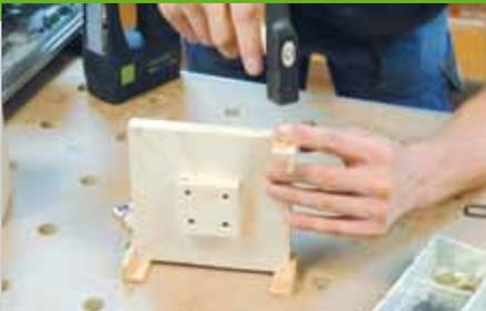
5. Bei der Gestaltung der Turmspitze sind der Fantasie keine Grenzen gesetzt. Verschrauben Sie auf der Plattform einen Holzklotz, auf dem Sie die Turmspitze festkleben können. Auf den Ecken werden Winkelleisten mit Kleber und Nägeln befestigt. Auf diesen Leisten wird später das Geländer festgeklebt.
