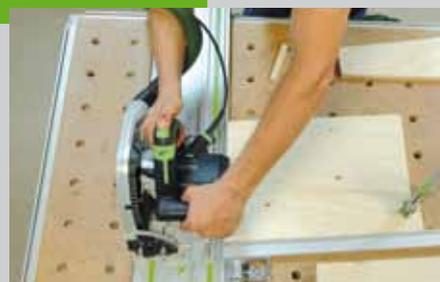
Beim Schneiden der Ober- und Unterkante der Wände (Pos. 1 + 2) wird das Sägeblatt um 5° geneigt. Es ist hilfreich, ein zweites Wandstück als Anschlag zu benutzen.
