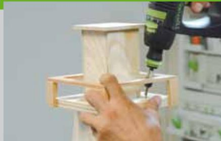
Wenn Sie Ihre Turmspitze fertig gestaltet haben, wird diese mit einer Schraube, welche als Drehpunkt dient, auf dem Turm befestigt. Zum Befüllen des Futterrohres im Inneren wird die gesamte Spitze einfach zur Seite weggedreht.
