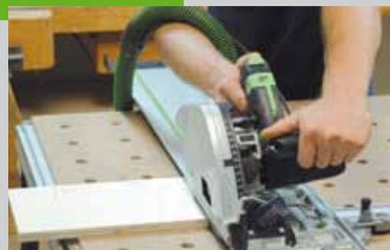
Die größere Platte schließt bündig mit den Turmaussenkanten ab. Alle Kanten der Bodenplatten sind um 5° angeschrägt.
