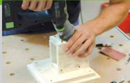
Hinter dem Rohr wird auf dem Halter eine zusätzliche Abstützung (Pos. 9) montiert. Vor dem Futterloch wird noch ein Halbkreis als Sitzfläche und als Trog für die Vögel montiert. Über das Futterloch kommt ein Vordach, das vor Regen schützen soll. Schneiden Sie ein Brett, aus dem Sie die Pos. 5 + 6 heraus schneiden, an einer Kante auf 5° schräg. Diese Kante ist die Befestigungskante
