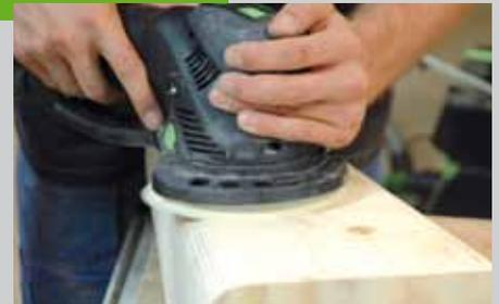
Die Außenecken des Turms können mit einer Oberfräse oder einem Handhobel abgerundet werden. Schleifen Sie dann alle Teile des Turmes mit einem Handschleifklotz und einem Exzentrerschleifer.
