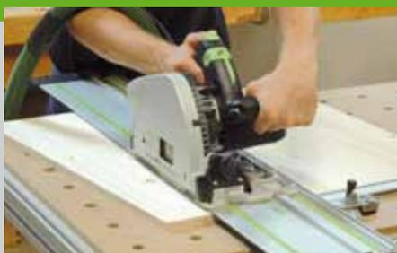
1. Schneiden Sie mit einer Handkreissäge mit Führungsschiene oder mit einer Tischkreissäge die Sperrholzplatten auf die in der Materialliste angegebenen Maße zu. Beim Zuschneiden mit dem auf dem im Bild gezeigten Multifunktions-tisch können Sie die Anschlag-
