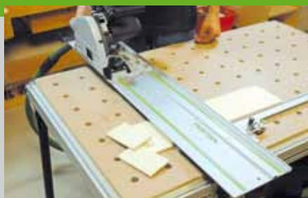
schiene auf 5° schräg stellen und dadurch die Wände des Hauses einfach und exakt zuschneiden. Beim Schneiden der 6 mm dicken Platten müssen Sie auf dem Tisch eine Schneidunterlage unterlegen, da die Mindestdicke mit der Anschlagsschiene 15 mm beträgt.
