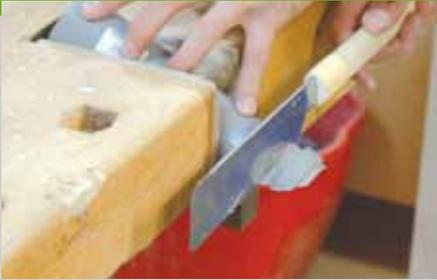
3. Halten Sie das Wasserrohr in den Turm und zeichnen Sie am unteren Ende (Pos. 17) die Schräge an, in der das Rohr abgeschnitten werden muss. Die Schnitte können mit einer Handsäge oder einem Winkelschleifer gemacht werden. Das Ebren erfolgt dann mit einem stationären Bandschleifer oder
