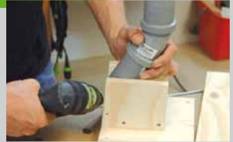
Dazu wird jeweils in den Seiten (Pos. 7) ein 3,5 mm Loch vorgebohrt. Die Einzelteile (Pos. 7 + 8) werden dann mit Spax 3,5 x 35 miteinander verschraubt. Verschrauben Sie die Halterung mit der kleinen Bodenplatte. Das Rohr wird seitlich mit der Halterung mit zwei Spax 3,5 x 16 verschraubt.
