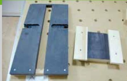
einem scharfen Stemmeisen entfernt. In die Seiten der Schubkästen wird eine Nut gefräst, mit der sie später auf der Führungsleiste gleiten. Um diese Nut fräsen zu können, müssen Sie eine Schablone bauen, in der die Kopierhülse der Oberfräse geführt ist. Das zweite Brett dient als Zulage von unten, um auch bei den schmalen Schubkästen die Schablone sicher spannen zu können.
