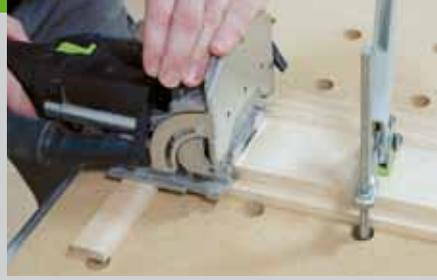
Durch diese Arbeitsweise werden kleine Ausrisse beim nächsten Fräsgang einfach weggefräst. Auf der Außenseite bekommt das Vorderstück eine Rundung ( $r=8\text{ mm}$ ). Markieren Sie die Positionen der Schubkastenteile mit dem Schreinerdreieck. In jede Ecke des Schubkastens werden mindestens zwei Dominolöcher Größe  $5 \times 30$  eingefräst. In Vorder- und Hinterstück beträgt die
