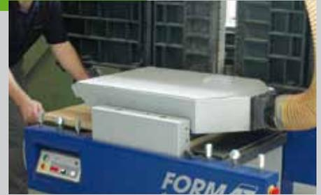
kommt es nicht zu einer Wölbung des Brettes. Am Rand des Brettes können Sie, wenn nötig, zum Ausrichten zwei Leisten quer darüber spannen. Wenn der Leim getrocknet ist, müssen die Leimreste mit einem Stemmeisen entfernt werden, da Leim die Hobelmaschine sehr schnell stumpf macht. Dann werden die Bretter mit der Hobelmaschine auf die fertige Dicke gehobelt.
