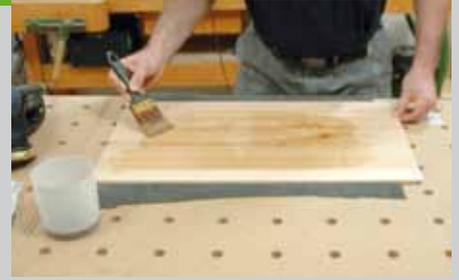
tenoberseite wird geschliffen. Bei geölten Oberflächen hat sich das Einschleifen der Grundierung bewährt. Dazu wird das Öl mit einem Pinsel aufgetragen und dann mit einem Exzenterschleifer und Schleifvlies Körnung A280 eingeschliffen. Das überschüssige Öl und der Schleifstaub müssen danach sofort mit einem Lappen abgenommen werden. Durch das Einschleifen entfällt der Zwischenschliff.
