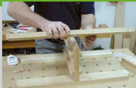
nicht unnötig in Hektik zu geraten. Geben Sie zunächst Leim in den Dominolöchern in der Mittelseite an und verleimen Sie Mittelseite und Traversen. Geben Sie dann in den Dominolöchern der Traversen und des Bodens Leim an und schlagen Sie die Verbinder ein. Geben Sie in den Gegenlöchern Leim an und stecken Sie alles zusammen. Vergessen Sie auch nicht die Querstrebe
