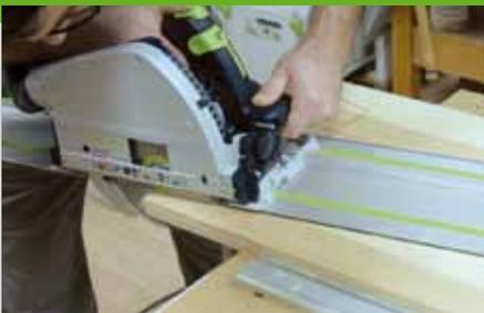
8. Auf der Unterseite der Seiten wird die Position der Ausschnitte für die Beine aufgezeichnet. Mit Tauchsäge und Führungsschiene werden die Beine ausgeschnitten. Entgraten Sie die Kanten der Gratleisten mit einem Handhobel und bereiten Sie dann alles vor, um den Korpus verleimen zu können. Legen Sie vor allem eine ausreichende Zwingenanzahl bereit, um
