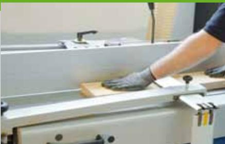
2. Die Bretter werden zunächst auf einer Hobelmaschine abgerichtet, d. h. die Seite, die auf der Maschine aufliegt, wird geplant. Sie sollten immer die bauchige Seite des Brettes nach unten nehmen. Das Brett muss so lange abgerichtet werden, bis auf einer Seite eine ebene Fläche entstanden ist. Falls das Brett in der Mitte noch roh ist macht das nichts, solange die Fläche am Rand
