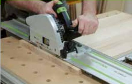
4. Schneiden Sie die Einzelteile auf das genaue Maß ab. Kennzeichnen Sie die spätere Position der einzelnen Teile mit dem Schreinerdreieck (Informationen zum Schreinerdreieck unter [www.kurswerkstatt.de](http://www.kurswerkstatt.de)). In die Seiten (Pos. 1) werden so genannte Gratnuten gefräst, das sind schwalbenschwanzförmige Nuten. In diese Nuten werden passende Gegenstücke (Gratleisten) eingeschoben; dadurch entsteht eine kraftschlüssige
