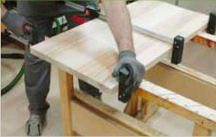
3. Legen Sie die einzelnen Bretter in der Reihenfolge wie Sie sie verleimen möchten zusammen. Um nichts zu verwechseln markieren Sie die Bretter auf der Oberseite mit einem Dreieck über jedes Bauteil. Auf den Kanten der Bretter wird mit einer Leimflasche oder einem Pinsel Leim angegeben. Mit Zwingen werden die einzelnen Bretter miteinander verspannt.
