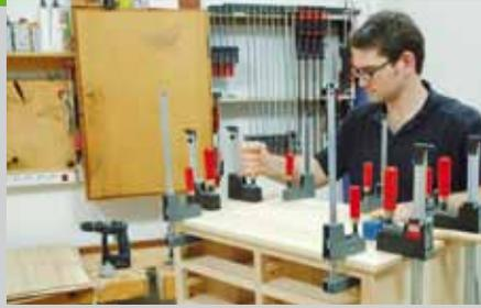
Letzter Schliff Körnung P 180. Die Dominos zum Befestigen der Platte werden zunächst in die Seiten eingeklebt. Dann wird in die Löchern in der Platte und auf den Traversen Leim gegeben und die Platte wird aufgelegt. Verspannen Sie alles mit Zwingen und kontrollieren Sie, ob auch alle Fugen dicht sind. Nach dem Aushärten werden alle Leimreste entfernt und die Plat-
