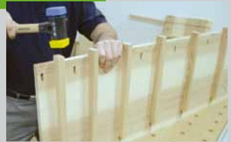
Fronseite bündig darauf fest. Fräsen Sie dann die Löcher für die Verbinder. Die Innenseiten der Seiten werden mit einem Exzentrerschleifer geschliffen, letzter Schliff Körnung P180. Die Gratleisten werden von der Frontseite aus in die Seiten eingeschoben, auf den vorderen 30 mm der Leiste wird etwas Leim angegeben und die Leiste wird vollständig in die Seite eingeschlagen.
