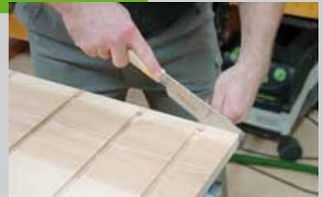
abgehobelt. Das bedeutet, der Grat hat auf der Frontseite noch die vollständige Breite und verjüngt sich dann zur Rückwand hin etwas. An der hinteren Kante der Seiten werden die Gratnuten mit passend zugeschnittenen Klötzchen ausgeleimt. Dadurch sind die Nuten auch von der Rückwand her geschlossen.
