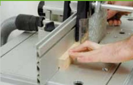
5. Die Gratleisten werden zunächst auf die angegebene Länge abgeschnitten. Um den Grat an den Leisten fräsen zu können ist ein Frästisch für die Oberfräse ideal. Sie können aber auch eine Oberfräse mit zwei Parallelanschlügen benutzen. Dabei wird der Abstand zwischen den Anschlägen so eingestellt, dass genau die Leiste dazwischen passt.
