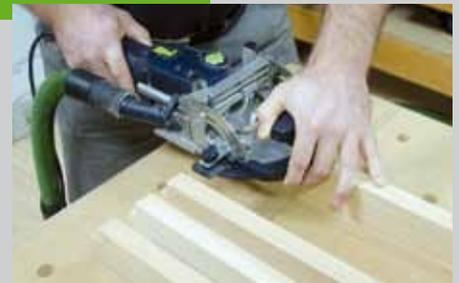
die Traversen zu fräsen. Auch die Verbindung zwischen den senkrechten Leisten des Frontrahmens und der Querleiste (Pos. 5) werden mit Dominos 5 x 30 hergestellt. An der Mittelseite werden die Verbindungslöcher in die aufgeleimte Frontblende eingefräst. Wenn alle Dominolöcher gefräst sind, werden die senkrechten Fronrahmen auf die Seiten aufgeleimt.
