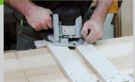
genau 20 mm (Dicke der Gratleiste) hat. Die Querbretter an der Schablone sind auch gleichzeitig die Anschläge, mit denen die Schablone am Brett angelegt wird. Befestigt wird die Konstruktion einfach mit Schrauben in die Innenseite der Bretter. Zeichnen Sie also die Positionen an und fräsen Sie die Nuten in die Seiten (Pos. 1) und in die Mittelseite (Pos. 10).
