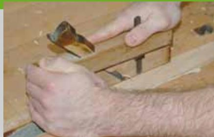
Am Frästisch wird die Tiefe der Gratnut durch Verschieben des Anschlag eingestellt. Der Grat kann auch mit einem Grathobel an der Leiste angehobelt werden. Zunächst wird der Grat so angefräst, dass die Leiste stramm in die Nut passt. Dann wird jede Leiste mit wenigen Hobelstößen leicht konisch
