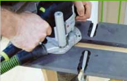
11. Spannen Sie die Schablone auf den Schubkastenseiten fest und fräsen Sie die Nuten. Die Schubkästen werden jetzt Stück für Stück in ihre spätere Position eingepasst. Es ist wichtig, dass seitlich und nach unten zwischen Führungsleisten und Nut ca.  $0,5\text{ mm}$  Luft auf jeder Seite sind. Zum Nacharbeiten kann an den Leisten mit einer Ziehklinge Material abgenommen
