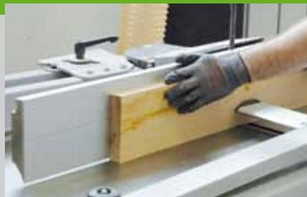
komplett abgehobelt ist. Danach wird eine Kante des Brettes gefügt, d. h. sie wird im rechten Winkel zur abgerichteten Fläche geplant. Dazu schieben Sie das Brett am Anschlag der Hobelmaschine entlang. Achten Sie darauf, dass der Anschlag auch im 90 Grad Winkel zum Tisch der Hobelmaschine steht. An allen Maschinen sollte die Handhaltung immer möglichst geschlossen ohne
