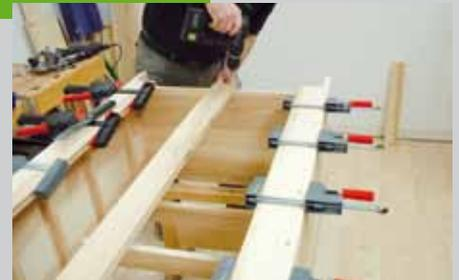
Unterseite bis zur Innenkante der Nut ausgeklinkt. Die Ausklinkung ist genau so breit wie der Boden dick ist. Zunächst werden die Dominos in den Rückwandrahmen eingeleimt, dann werden die Seiten des Rückwandrahmens mit den Seiten der Kommoden stumpf verleimt. Unten werden die drei Bretter mit Holznägeln (Fa. Dick) am Boden befestigt.
