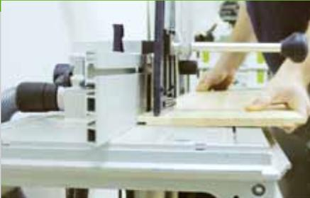
10. Prüfen Sie beim Verleimen der Schubkästen die Winkligkeit durch Messen der Diagonalmaße. Die Schubkastenböden und die Rückwände bekommen auf drei Seiten einen Falz, um die Materialdicke zu reduzieren. Dieser wird wie zuvor beschrieben mit einer Oberfräse oder einer Tischfräse hergestellt. Nach dem Ausspannen wird der überschüssige Leim an den Schubkästen mit
