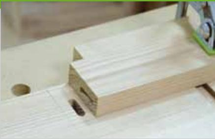
6. Bevor die Gratleisten eingeleimt werden können, müssen die Dübellöcher, die die Seiten und Mittelseite mit Traversen (Pos. 8 + 9) bzw. die Seiten und den Boden verbinden, eingefräst werden. An der Mittelseite (Pos. 10) wird an der Vorderkante eine 22 mm dicke Leiste als Frontblende aufgeleimt. Die Traversen werden auf der Vorderseite mit der Tischkreissäge ausgeklinkt. Zeichnen Sie die genaue Position der
