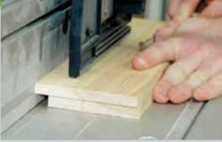
9. Die Schubkastenfronten werden rundherum gefalzt. Am besten fräsen Sie den Falz mit einer stationären Fräse oder einer Handoberfräse. Fräsen Sie zunächst die erste Kante quer zur Faser und benutzen Sie ein Nachschiebeholz um Ausrisse zu vermeiden. Drehen Sie das Brett dann gegen den Urzeigersinn und fräsen Sie die nächste Längskante, dann wieder quer und wieder längs.
