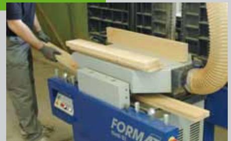
abgespreizte Finger sein. Gummierete Arbeitshandschuhe schützen vor Verletzungen und erleichtern die Kraftübertragung auf das Brett. Danach werden die Bretter zunächst in der Breite, dann in der Dicke durch die Hobelmaschine gelassen. Die Bretter, die verleimt werden, sollten 2 mm dicker als das Fertigmaß bleiben.
