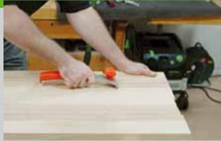
Solange die Zwingen noch nicht fest angezogen sind, können Sie die Bretter noch in der Dicke zueinander verschieben. Setzen Sie zuerst die mittlere Zwinke an und richten Sie die Bretter aus. Dann wird zunächst in die eine und dann in die andere Richtung Zwinke für Zwinke angesetzt und alles ausgerichtet. Wenn Sie die Zwingen im Wechsel von unten und von oben ansetzen,
