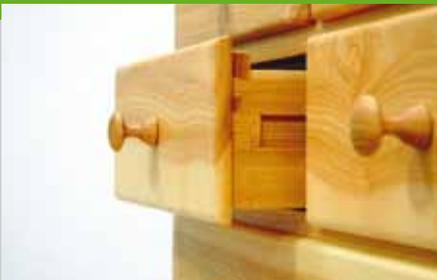
13. Die Löcher für die Griffe werden erst jetzt in die Fronten gebohrt. Dabei dient ein Klotz, mit einem auf der Ständerbohrmaschine gebohrten Loch, als Führung und Anschlag. Die zuvor geölten Knöpfe werden mit Leim in die Löcher eingeschlagen. Mindestens zwei weitere Ölschichten werden danach dünn mit einem Lappen aufgetragen.
