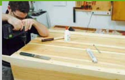
Schieben Sie die Schubkastenböden und die Rückwände in die Nuten ein und befestigen Sie sie auf der Unterseite mit Holznägeln. Damit die Schubkästen richtig gut laufen, sollte auf den Nutleisten etwas Vaseline aufgetragen werden. Durch mehrmaliges hin und her schieben verteilt sich diese dann gleichmäßig und der Schubkasten wird
