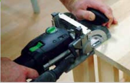
12. Fräsen Sie an die Unterseite der Platte eine Rundung ( $r = 12 \text{ mm}$ ). Zeichnen Sie den Überstand und die Materialdicke der Seite auf der Plattenunterseite an. Fräsen Sie in der Plattenunterseite und in den Seiten Dominolöcher (für Dominos  $8 \times 40$ ). Der Korpus und die Unterseite der Platte werden komplett geschliffen, die Kanten nur mit einem Handschleifklotz gebrochen.
