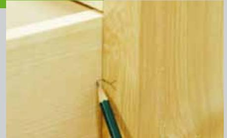
Damit die Schablone auf den Seiten nicht verrutschen kann, sollten Sie auf der Unterseite Schleifpapier aufleimen. Die genaue Position der Nut wird direkt am Korpus angezeichnet. Legen Sie Abstandsleisten mit zwei Millimeter Dicke unter die Schubkästen und zeichnen Sie die genaue Position der Führungsleisten an.
