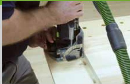
Traversen an. Spannen Sie dann die Traversen mit der Unterseite auf der Seite aufliegend genau an der späteren Position fest. In unserem Beispiel werden Löcher für Dominos mit der Größe 8 x 40 mm gefräst. Die Breite der Löcher ist 5 mm breiter als der Verbinder. Auch in der Mittelseite werden die Löcher für die Verbinder eingefräst. Legen Sie dann den Boden auf die Seiten auf und spannen Sie ihn mit der
