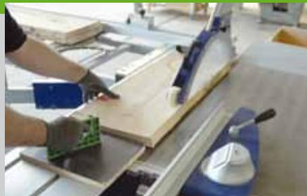
Falls Sie sich bei einer Stelle trotzdem unsicher sind, hobeln Sie das Brett kurz mit einem Handhobel an. Schneiden Sie die Bohlen an den Strichen auseinander. Die Bretter werden zunächst mit der Handkreissäge und einer Führungsschiene oder mit einer Formatkreissäge „besäumt“, die Baumkante wird entfernt. Egal welche Säge Sie benutzen,
