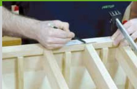
hin schräg abgeschnitten. Spannen Sie die Fronrahmen auf die Seiten und zeichnen Sie die Positionen der Traversen darauf an. In die Mitten der Traversen wird jeweils ein Loch für einen Domino (Größe 5 x 30) gefräst. Das Loch ist genau so breit wie der Verbinder, die Frästiefe beträgt 15 mm. Fräsen Sie zunächst die Löcher in den Fronrahmen und montieren Sie dann den Leistenanschlag, um die Löcher in
