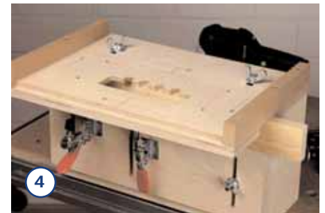
Anschlag umbauen und Werkstück von der Seite einschieben.
