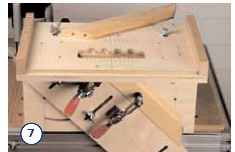
Beim Dübeln von Gehrungen wird zunächst der Anschlag schräg gestellt. Dann wird das Werkstück mit dem Schnellspanner fixiert und ein bis zwei Dübellöcher gebohrt.
