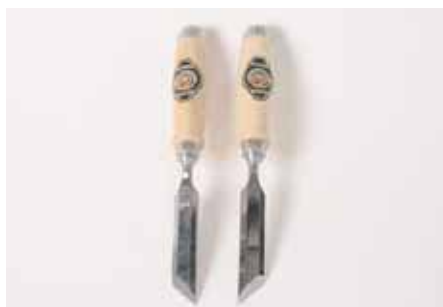
Eine weitere Variante von Stemmeisen sind die Schrägbeitel, sie sind rechts oder links abgeschragt erhältlich.
