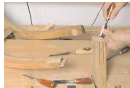
Die Kurzbeitel liegen gut in der Hand und können ohne Klüpfel z. B. bei Restaurierungsarbeiten verwendet werden.
