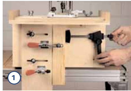
Das Spannelement (Festool Best.Nr.: 488030) wird einfach in der 20 mm Bohrung befestigt und hält das Werkstück auch bei größerem Druck von oben sicher fest. Die Schnellspanner alleine reichen beim Dübeln nicht aus!
