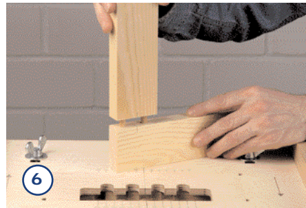
Zum Schluss stecken Sie die Dübel ein und überprüfen die Passgenauigkeit der Verbindung.
