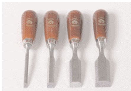
Seit kurzem werden so genannte "Kurzbeitel" angeboten, Sie haben eine Gesamtlänge von 160 mm und eignen sich für Arbeiten in engen Bereichen, dort wo normale Stemmeisen zu lang sind.
