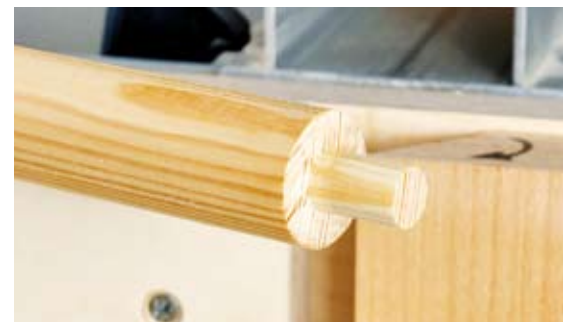
Mit der passenden Vorrichtung können Sie auch an Rundstäben problemlos einen runden Zapfen anfräsen. Auch hier ist mit einer weiteren Vorrichtung eine hohlkehlförmige Brüstung möglich.
