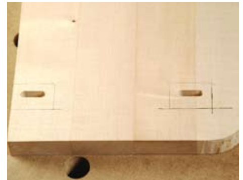
Beim Vorschliff entfernt man sämtliche Unebenheiten, Markierungen und Verschmutzungen wie Harzflecken und Leimreste.
