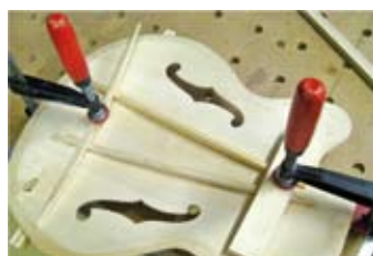
6. Leimen der Verstärkungsleisten
