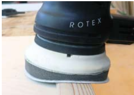
14. Für einen gleichmäßigen Feinschliff der profilierten Oberfläche eignet sich das FESTOOL Interface-Pad als weiche Zwischenlage von Schleifteller und Schleifscheibe.
