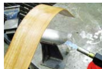
7. Biegen der Seiten über einem mit der Lötlampe erhitzten Alurohr
