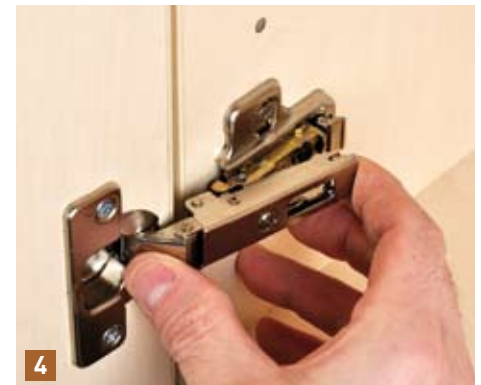
Das Einhängen der Türen geht ohne Werkzeug, Dazu müssen nur die Gelenkarme der Topfscharniere nacheinander in die Montageplatten eingeklickt werden.
