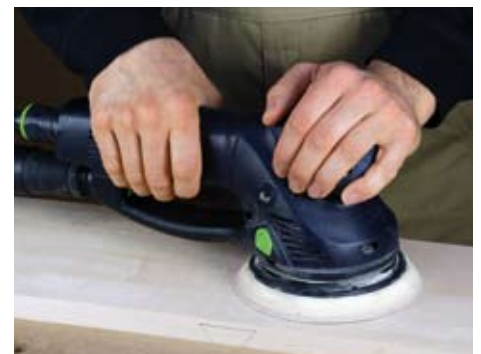
Begonnen wird je nach Zustand der Oberfläche mit der Körnung 80 bis 120.
