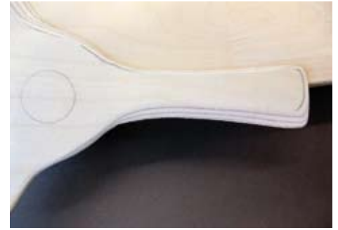
12. Nun geht es an die Übergänge. Diese sollten von der Rundung gleichmäßig zur Schräge hin verlaufen. Die saubere Bearbeitung zeichnet sich auch hier wieder durch eine saubere Linienführung ab. Die Übergänge lassen sich am besten mit der Halbrundfeile oder mit der Delta-tellerspitze bearbeiten.
